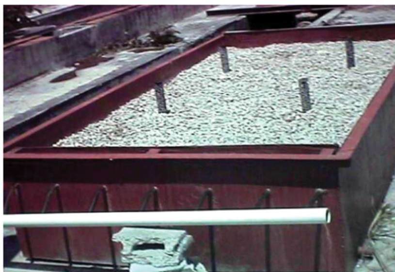
Figura 1.- Modelo físico concebido para el estudio del flujo y dispositivo de salida (Figura extraída del documento original).
